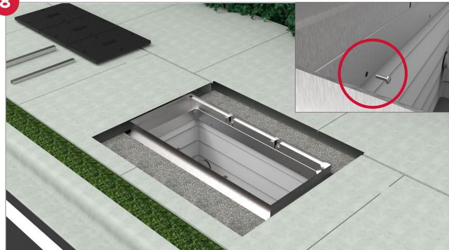
Installieren Sie den Rahmen nach lokaler Methode oder verwenden Sie bei Bedarf Befestigungsbolzen zur Befestigung am Brunnen.
