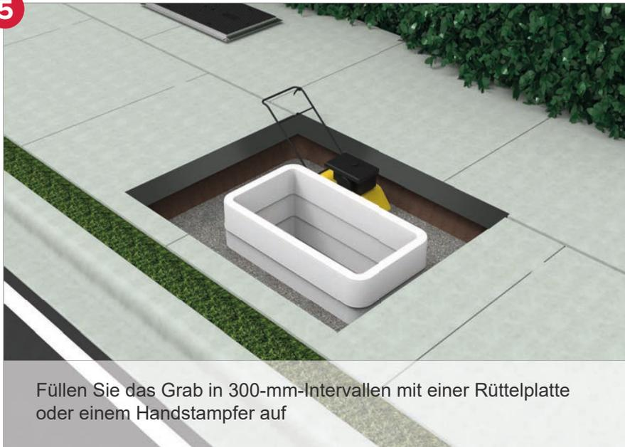
Füllen Sie das Grab in 300-mm-Intervallen mit einer Rüttelplatte oder einem Handstampfer auf
